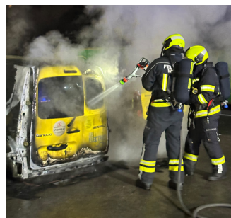
Unter schwerem Atemschutz wurde die Batterie gelöscht und weiter gekühlt.
