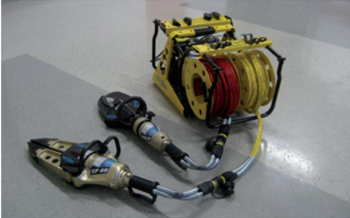
Das neue Gerät arbeitet schneller, das Wechseln der Werkzeuge ist einfacher und die Schere schneidet den in neuen KFZ-Modellen verwendeten hochfesten Stahl.
