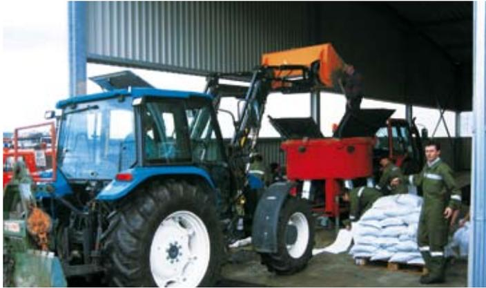
Einsatz der neuen Sand-sack-Füllmaschine und der Mithilfe von freiwilligen Helfern und den Kameraden der Feuerwehr Höflein. Mit dem 2005 vom Katastrophenfonds des Bezirkes Urfahr-Umgebung angeschafften Gerät können in der Stunde bis zu 20 Tonnen Sand abgefüllt werden.
